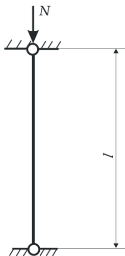
Рис. 2.11 – Розрахункова схема колони Розрахункове значення нормальної стискаючої сили (кН):
