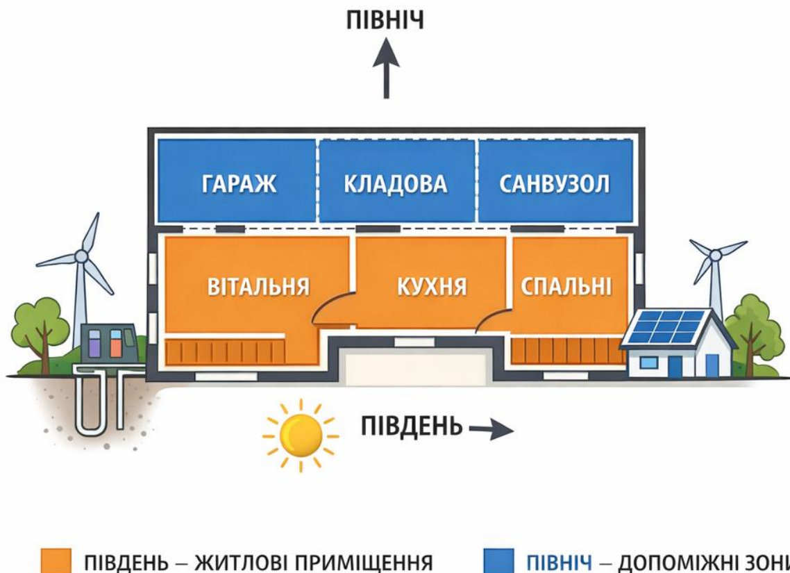
Рис. 1 – Схема орієнтації та зонування малоповерхового житлового будинку (південь – житлові приміщення, північ – допоміжні зони)
