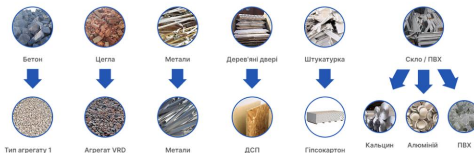
Рис. 1 – Схема переробки основних видів будівельних відходів у вторинні матеріали (бетон, цегла, метали, дерев'яні двері, штукатурка, скло/ПВХ)
