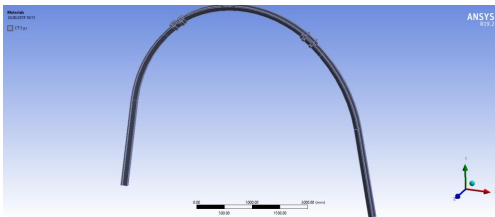
Рис. 1 – Просторова розрахункова схема (у середовищі розрахункового комплексу ANSYS Workbench) 3-ланкового шатрового піддатливого кріплення КШПУМ-20,3
