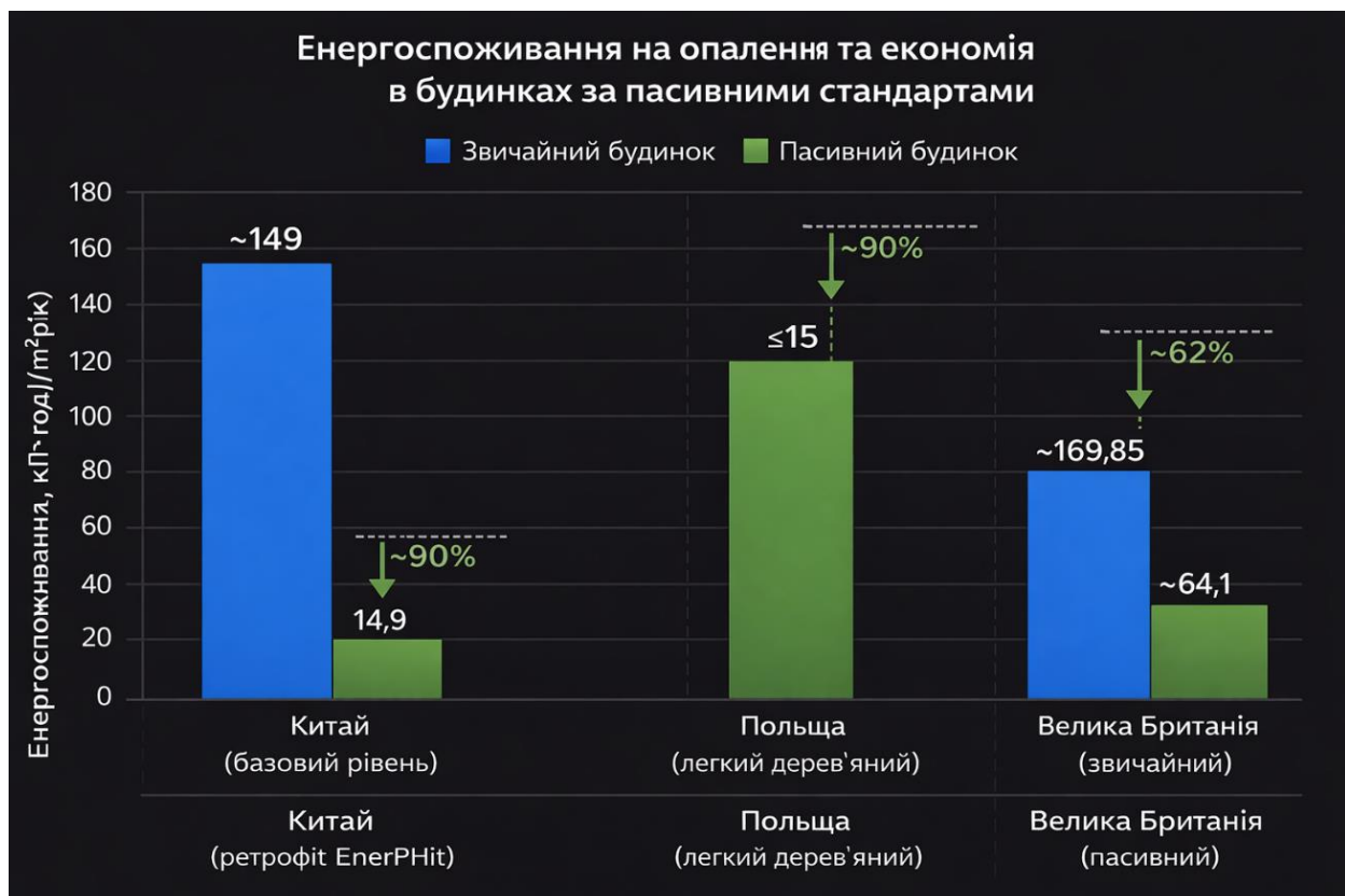
Рис. 2 – Порівняння енергоспоживання малоповерхових пасивних будинків із звичайними
