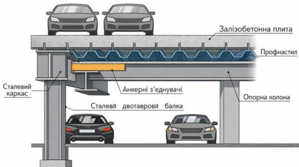
Рис. 1 – Схема композитного перекриття багаторівневого паркінгу
