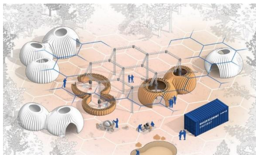
Рис.1 – Інноваційний будинок TECLA, сконструйований за принципом осинового гнізда та надрукований на 3D-принтері з глини з додаванням соломи (саманом)
