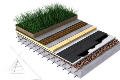
Рис.2 – Конструкція інверсійної покрівлі
