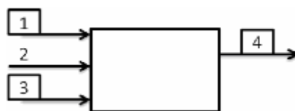
1 – положение балансира; 2 – масса балансира; 3 – ход штанги; 4 – координата центра масс, момент на привод Рисунок 3 – Схема вычислительного эксперимента
