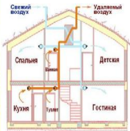
Рис. 2 Система вентиляции в пассивном доме.
