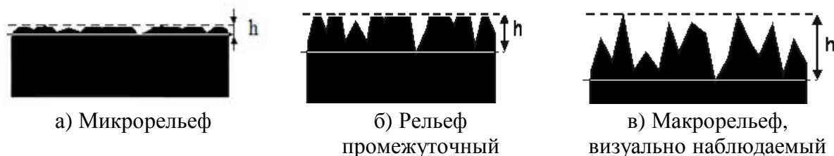
Рис. 2 – Модель, характеризующая микрорельеф поверхности с проявлением его поверхностных свойств а), макрорельеф – с доминированием зацепления и рельеф обработанной поверхности б) с перераспределением вклада между механической и физико-химической формами взаимодействия
