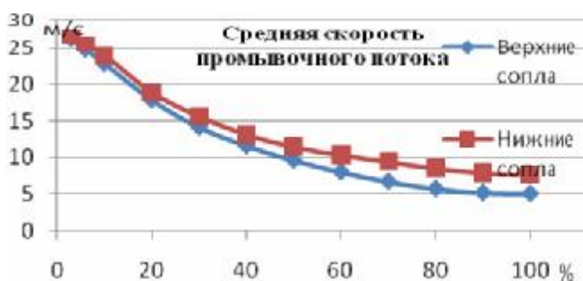
Рисунок 3 – Зависимость полезного расхода промывочного потока от степени открытия сопла очистителя
