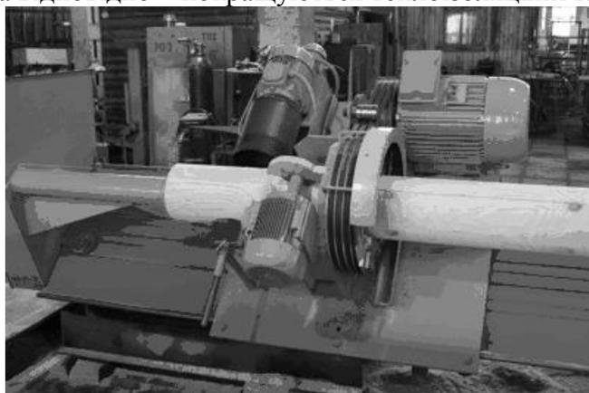
Для вибору пазу і чашок використовують спеціалізоване обладнання, що дозволяє отримати оциліндровані колоди, які ідеально прилягають одна до одної (рис.4). Використання ручного інструменту не дозволяє отримати такої якості і точності з'єднань. Для захисту стін від вогню та грибків рекомендується використовувати метод глибокого просочування деревини антисептиками та антипіренами в автоклавах (рис 5).
