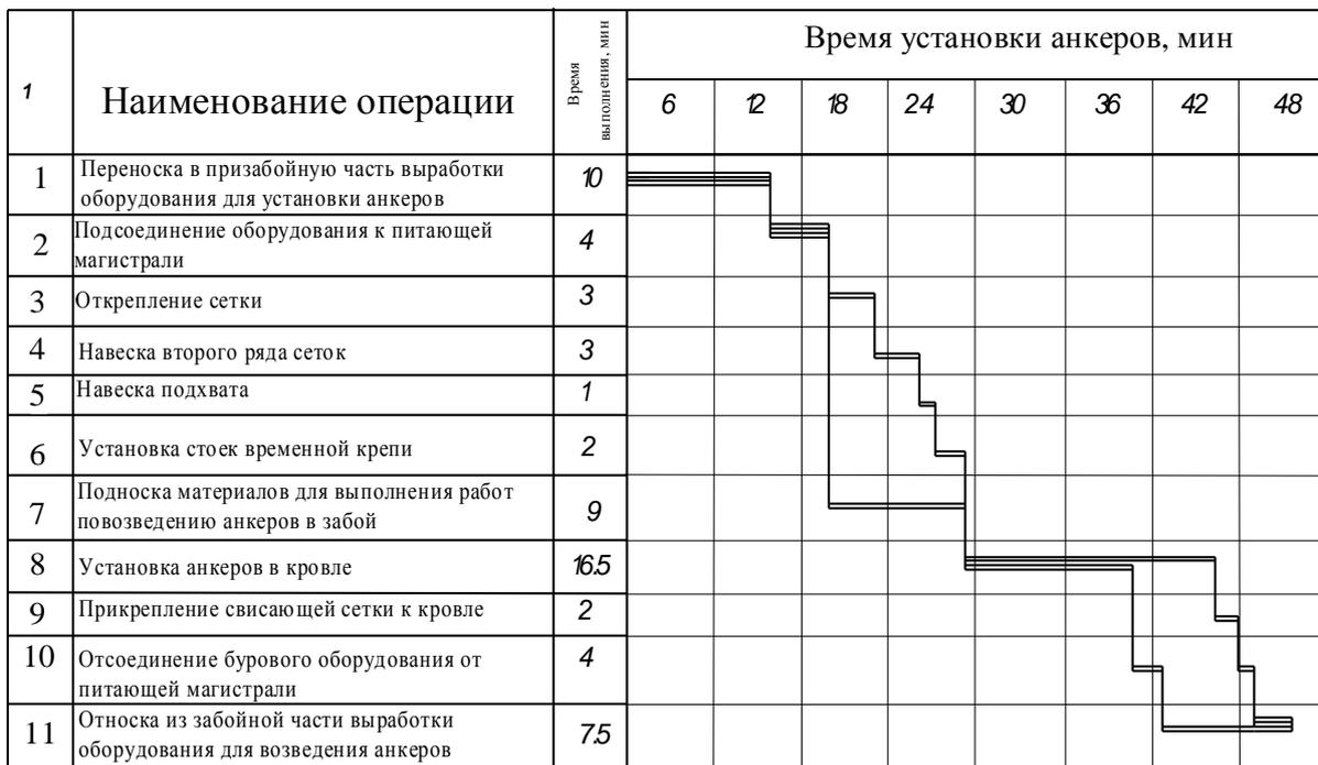
Рисунок 3 – График организации работ по установке пяти сталеполимерных жестко-податливых анкеров в кровле выработки
