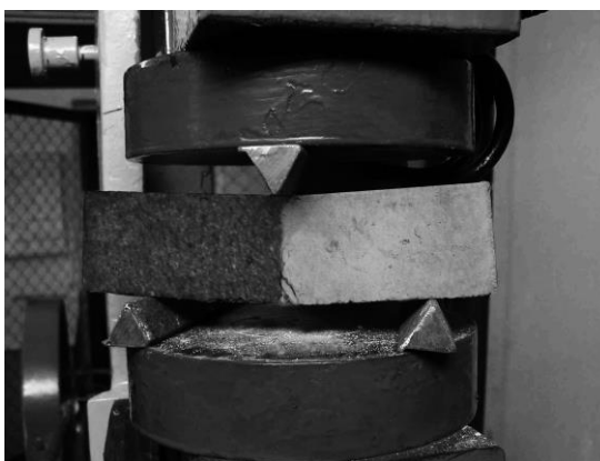
Рис.2. Испытание образцов-балочек на растяжение при изгибе.
