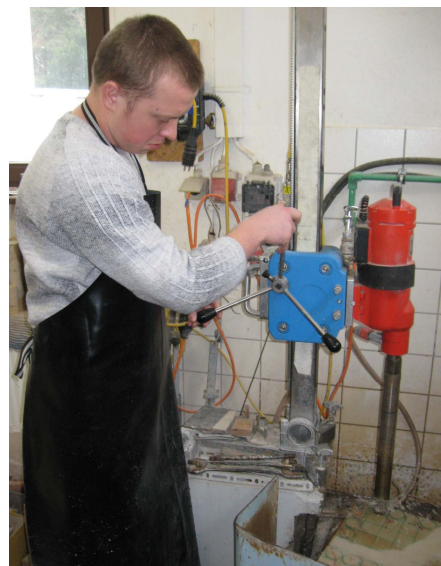
Подготовка образцов горных пород для испытаний в лаборатории Фрайбергской горной академии
