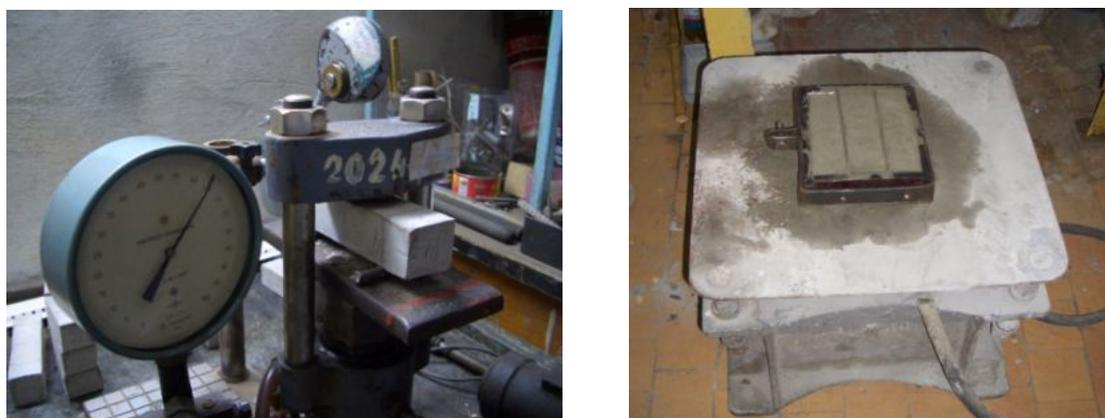
*Рис. 1 Испытание фибробетонных образцов*
