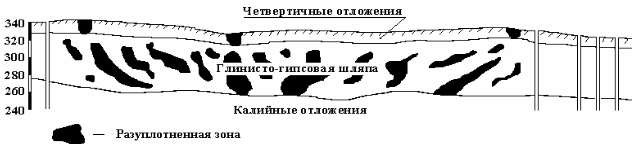
Рис. 2. Разрез рудника №2 с выявленными разуплотненными зонами
